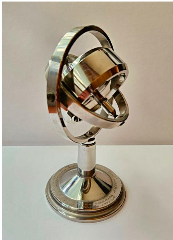
Рис. 1. Модель гироскопа в кардановом подвесе
