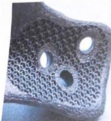
Рис. 3. Структурирование поверхности протеза для улучшения срастания биологического материала с протезом
