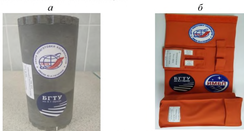
Рис. 1. Фото контейнера из разработанного полимерного композита (а) и научной аппаратуры (б) для целевой работы «Защитный композит»
