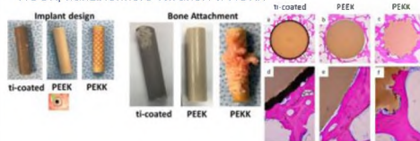
Фотография и микрофотография структуры имплантатов (до и после операции [извлечение через 16 недель])
