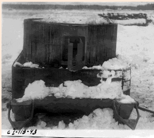
Башня танка с решетчатой защитой, полигонные испытания, 1943 г.
