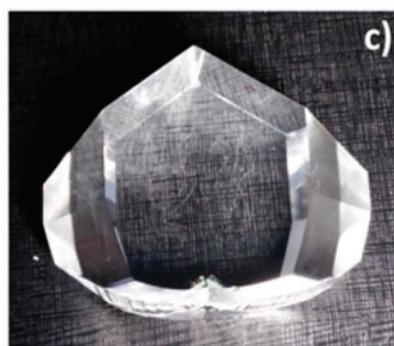
**Рис. 1.** Фотографии монокристалла LBO, выращенных на на высокочистом насыщенном кислородом  $\text{MoO}_3$  без дефектов
