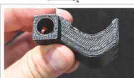
**ПОСЛОЙНОЕ НАНЕСЕНИЕ РАСПЛАВЛЕННОЙ ПОЛИМЕРНОЙ НИТИ ДЛЯ ФОРМИРОВАНИЯ ИЗДЕЛИЯ**
