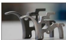
Спусковой механизм из титана для винтовки AR-15, изготовленный MIM методом и показанный в состоянии «зеленой» и спеченной детали, изготовлен Mimest SpA, Тренто, Италия
