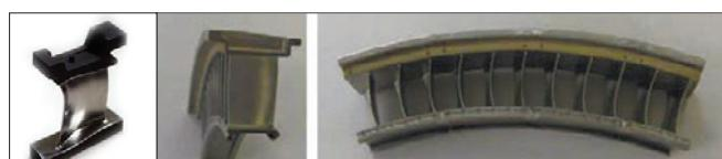
Единичная MIM лопасть компрессора (а) и MIM блок лопастей (б), изготовленные из жаропрочного сплава IN718 (Maetta Sciences, Pratt and Whitney)
