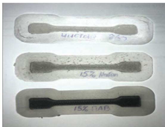
**Рис. 1.** Фотография напечатанных образцов полиэтилена: верхний – исходный материал, средний – модифицированный волокнами Нафен, нижний – модифицированный нановолокном Нафен, функционализированный олеиновой кислотой
