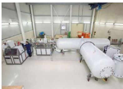
Ускоритель ионов TANDETRON
