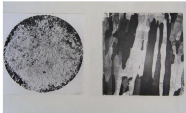
Детали структуры слитка сплава ТСМ-7
