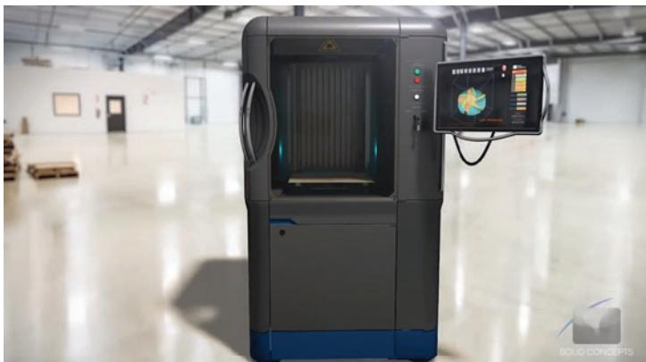
Фотополимеризация – процесс, в котором жидкий фотополимер выборочно отверждается (полимеризуется) в ванне световым излучением
