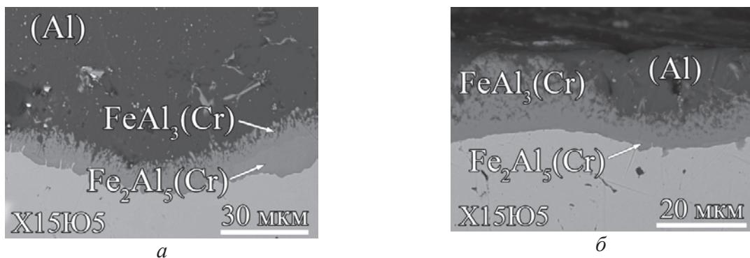
Рис. 3. Структура покрытия после алитирования сплава X15Ю5 в расплаве алюминия без воздействия УЗ (а) и с УЗ (б)
