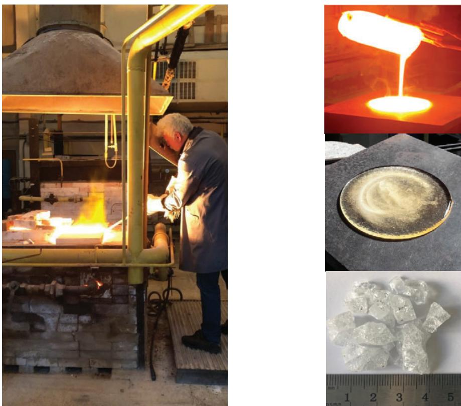
**Рис.** Синтез стекла в газовой горшковой печи и полученный гранулят
