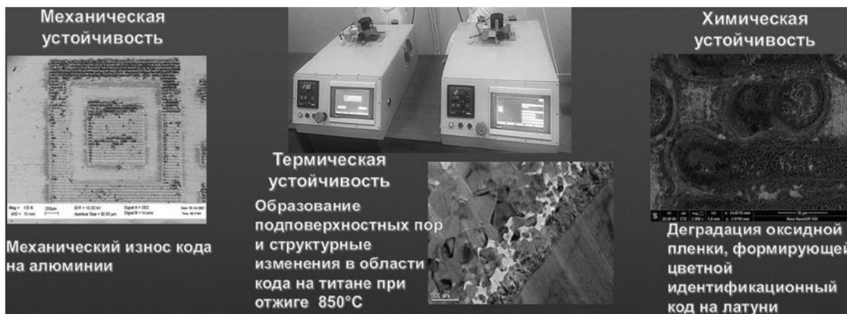
**Рис. 1.** Двухмодульный компьютеризированный испытательный стенд для определения механической и химической устойчивости лазерно-индуцированных идентификационных штрих-кодов в широком интервале температур, в том числе в растворах с различной величиной pH
