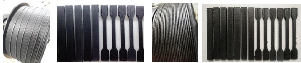
Свойства напечатанных образцов на основе угленаполненного ПЭИ
