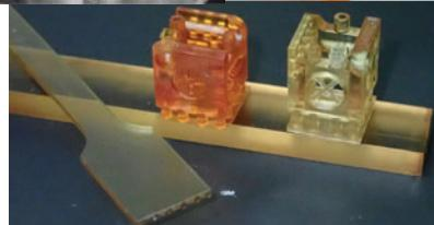
Задел: Разработаны ФПК с вязкостью 200-600 мПа·с для 3D-печати в условиях облучения источником LED 405 нм. Полученные на их основе материалы характеризуются теплостойкостью по HDT до 137 °C при прочности при растяжении до 87 МПа и твердости по Шор Д 89 усл.ед.
