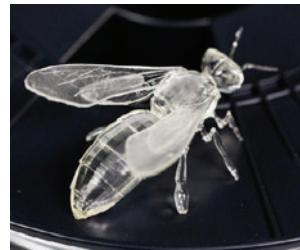
Фотополимеризация – процесс, в котором жидкий фотополимер выборочно отверждается (полимеризуется) в ванне световым излучением
