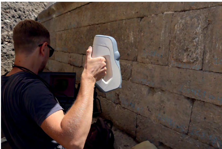
Илл. 41. ОАН «Южный пригород древнего города Херсонес Таврический». Сканирование каменных конструкций с помощью 3D- сканера
