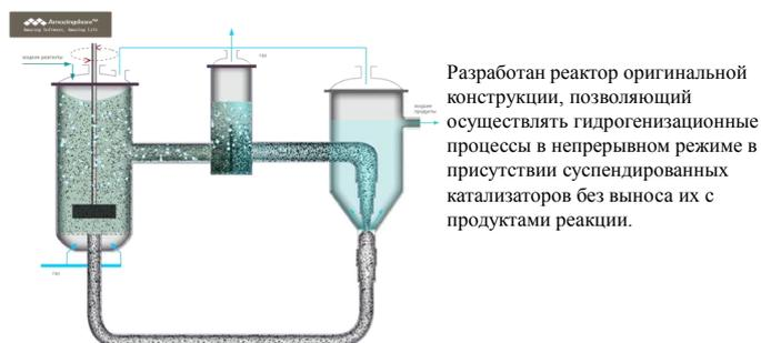
Разработанные решения позволяют добиться усовершенствования периодической технологии с уходом от растворителя (СНЗОН), использования пирофорного скелетного никеля, повышенных (до 25 бар) давлений Н<sub>2</sub>. Разработанная технология может быть реализована как в непрерывном, так и в периодическом вариантах.
