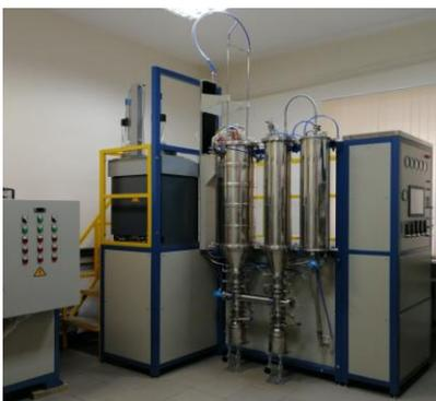
Установка плазменной сфероидизации металлических порошков ИМЕТ РАН
