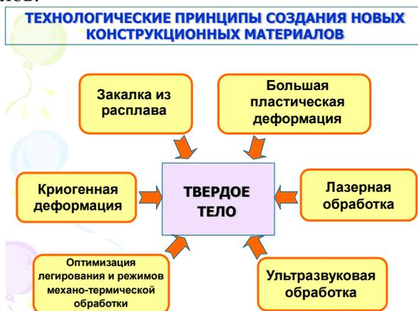
Несколько эффективных методов ЭВ: закалка из жидкого состояния, большие и криогенные пластические деформации, лазерная и ультразвуковая обработки.
